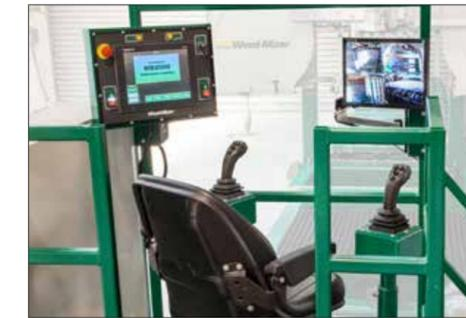
La producción depende del operador, y los controles para la WB2000 fueron diseñados con la mente del operador. De la plataforma de mando está posicionada en el final del aserrado con la cabeza aserrando hacia el operador. El asiento del operador está situado de modo que el ángulo de visión proporciona una línea de visión clara y sin obstrucciones.
